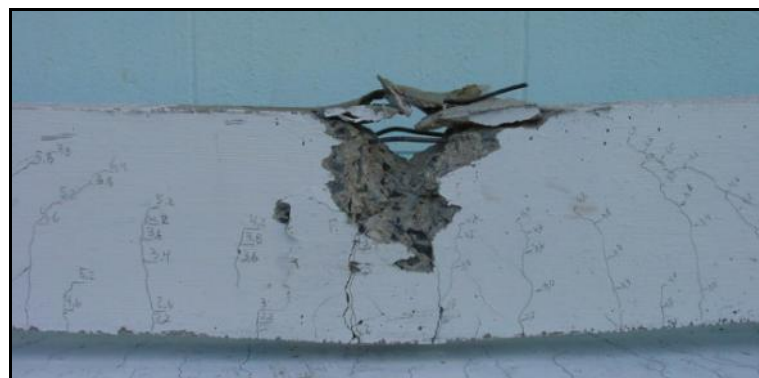
Figura 18 – Configuração de uma viga pós-ruptura: esmagamento do concreto
