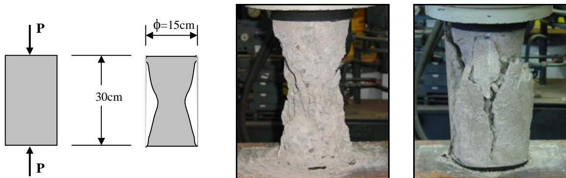
Figura 2 – Aspecto característico da ruptura dos corpos-de-prova de concreto.
