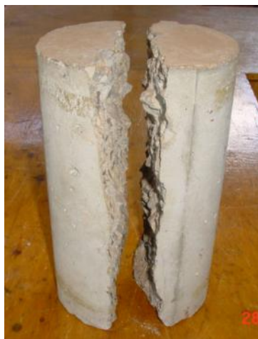
Figura 4 – Forma de ruptura de um corpo-de-prova: compressão diametral
